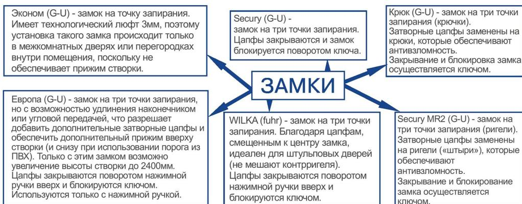
Большую роль играет выбор сердцевины для замка. От качественных характеристик и конфигурации этого механизма зависит, насколько надежно защищен Ваш дом и стать непреодолимой преградой на пути злоумышленников. Использование регильного (многозатворного) замка не позволяет выломать металлопластиковые или алюминиевые двери из рамы, за счет роликов и соответствующих планок, размещенных по высоте двери.
