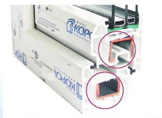
Специальные упоры обеспечивают воздушную прослойку между армированием и профилем, предотвращая потери тепла по монтажному шву.
